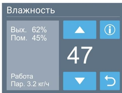
Для изменения температуры, влажности (доступно только при наличии увлажнителя) или скорости вентилятора (может быть недоступно в режиме VAV) нажмите на область, где отображается этот параметр. Откроется новое окно, в котором будет показана заданная
